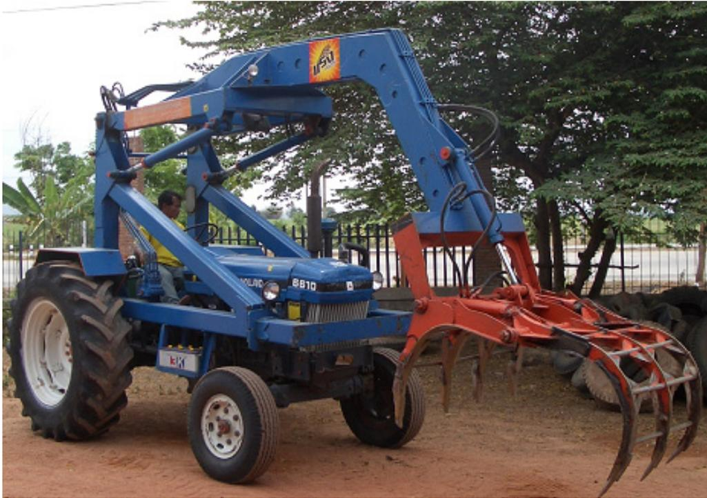
写真 2.3 サトウキビ収穫用機械(タイ製)
