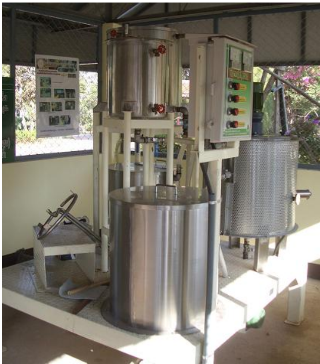
写真 8 DEDE によるバイオディーゼル製造機
